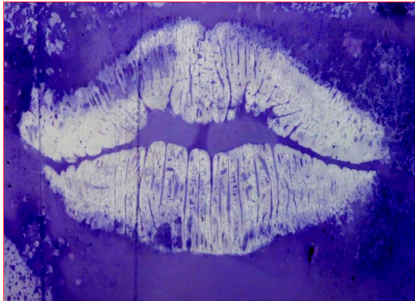
Fig. 15 - Revelado de huella latente sobre cinta adhesiva con revelador líquido de “violeta de genciana”. Fonte - (Foto archivo de Drs. Simonetti-Benítez).
